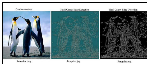
Gambar 2. 12 Ilustrasi Penerapan Algoritma Canny pada Citra
