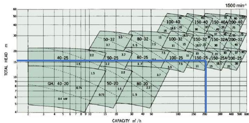
Berdasarkan grafik di atas, maka dipilih centrifugal pump dengan merek Shinko GHJ dengan tipe 150-25 dengan spesifikasi yang tertera pada lampiran A.
