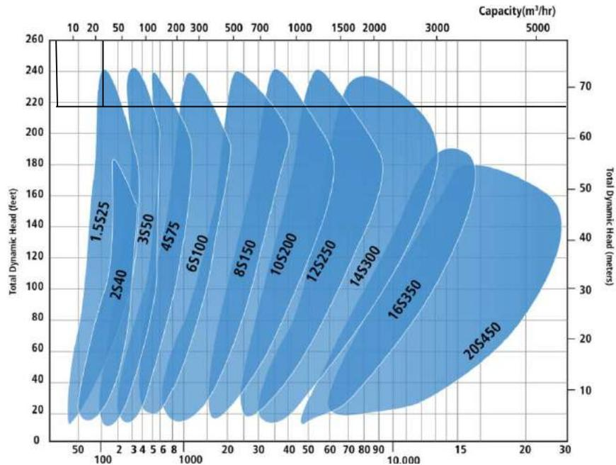
Berdasarkan grafik di atas, maka dipilih pompa dengan merek Schurco *Slurry Pump* S Series tipe 1,5S25 dengan spesifikasi yang tertera pada lampiran A.
