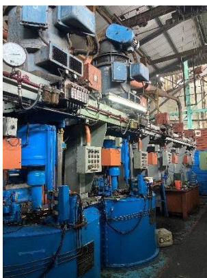
High Grade Fugal yang digunakan untuk gula hasil masakan pan C dan D
