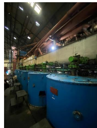
Low Grade Fugal yang digunakan untuk gula hasil masakan pan A
