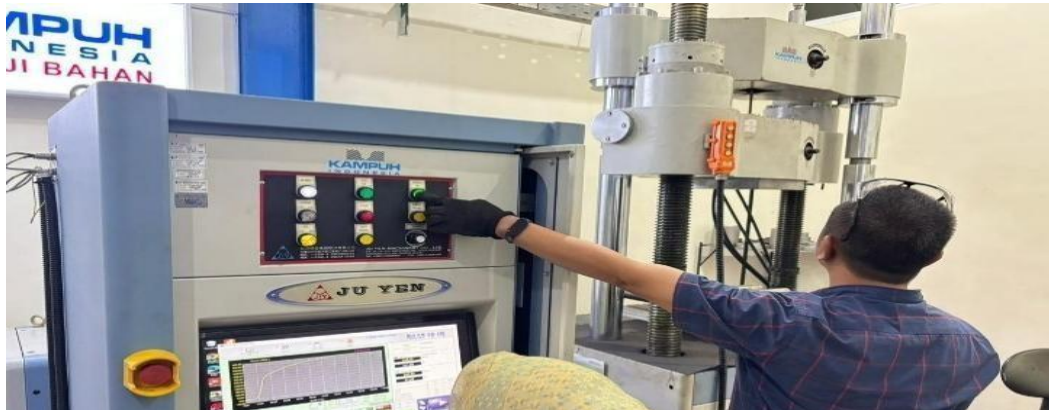
Gambar 11. 5 Pengujian tarik besi di laboratorium Sumber : Dokumen Pribadi, 2025
