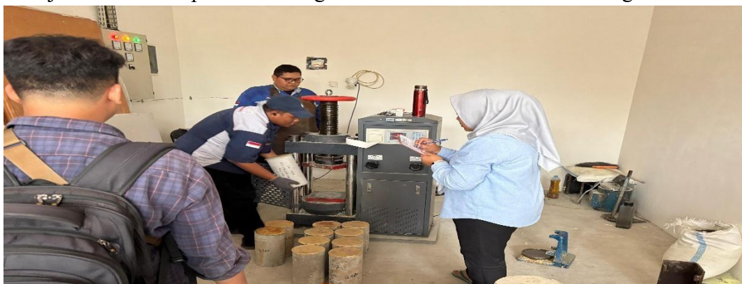
Gambar 11. 13 Kegiatan uji kuat tekan beton pada laboratorium Sumber : Dokumen Perusahaan, 2025
