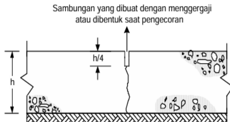
Gambar 2.16 Sambungan susut melintang tanpa ruji (Sumber : Dokumentasi Pribadi)
