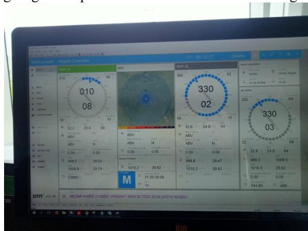
Gambar 3.2 Visual dari Display AWS.
