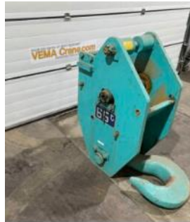
Gambar 6.17 Hook Crane Sumber : PT Parama Karya Mandiri KSO (2025)
