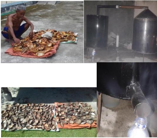
Gambar 5 Proses pembuatan asap cair
