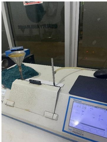
Gambar 13. Analisis Brix, Pol, dan HK pada Sampel Gilingan
