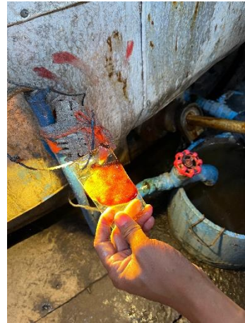
Gambar 6. Mengecek Pengkrisalan Gula d di Stasiun Pemasakan
