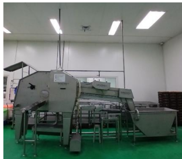
Gambar 12. Mesin Egg Breaker (Sumber: Dokumentasi Pribadi, 2025)
