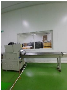
Gambar 25. Mesin Pengemasan Primer “Almond Tart”
