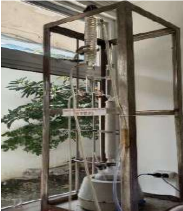
Gambar 2. Seperangkat alat distilasi batch dilengkapi kolom distilasi dan kondensor.
