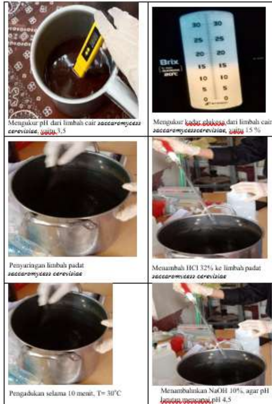
Gambar 1. Proses bioethanol dari limbah cair Saccharomyces Cerevisiae dengan proses hidrolisis
