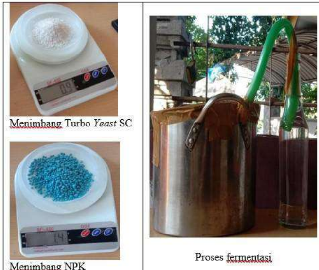
Gambar 2. Proses bioethanol dari limbah cair Saccharomyces Cerevisiae dengan proses fermentasi
