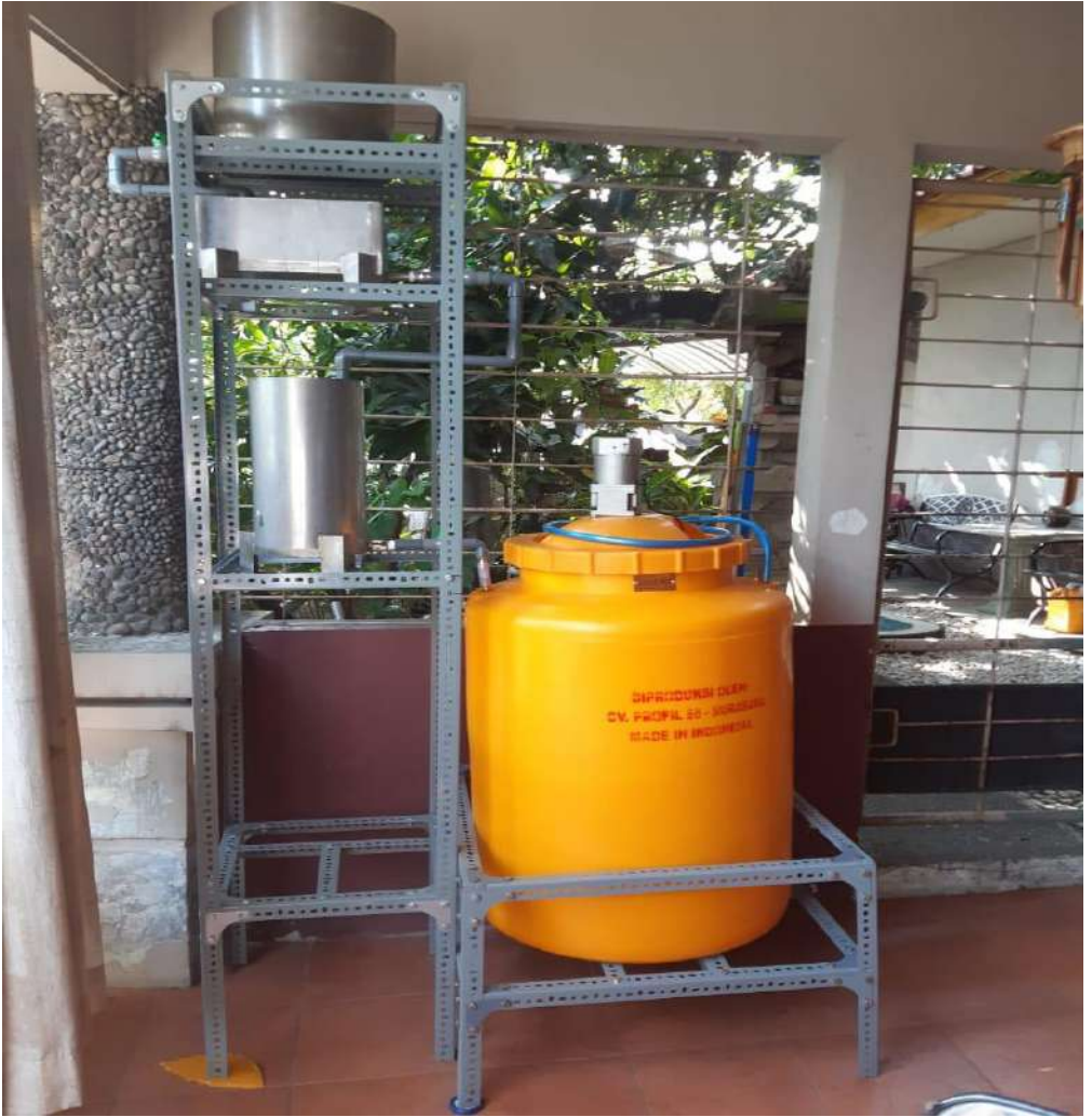
Gambar 2. Proses produksi bioethanol dengan proses hidrolisis secara kontinyu dan proses fermentasi secara batch.
