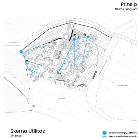
Gambar 6. 16 Skema Utilitas Air Bersih
