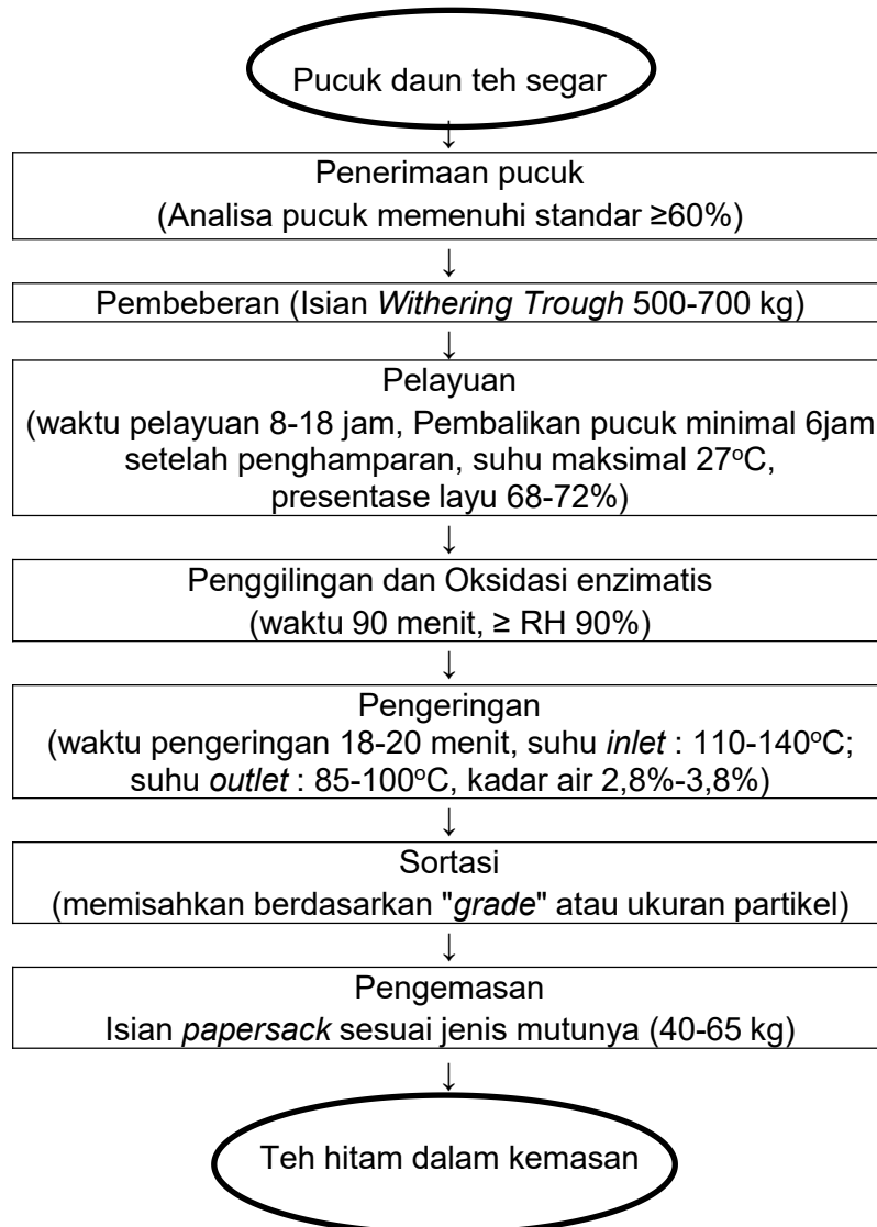
Gambar 7. Diagram Alir Proses Pengolahan Teh Hitam CTC PT Perkebunan Nusantara XII Kebun Wonosari
