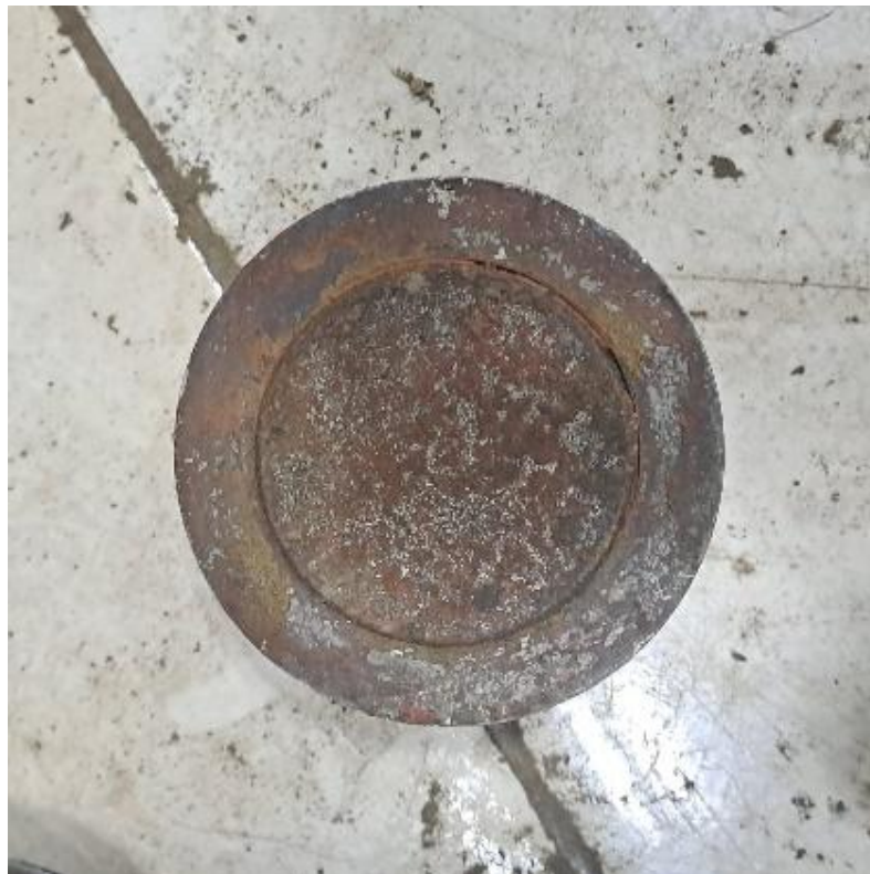
Gambar 3. 14 Slagging pada Filter Difusi
