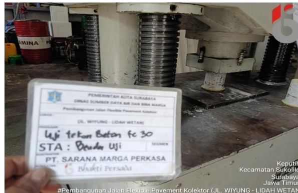
Gambar 4.2 Pengujian Kuat Tekan Beton (sumber : Dokumen Pribadi)
