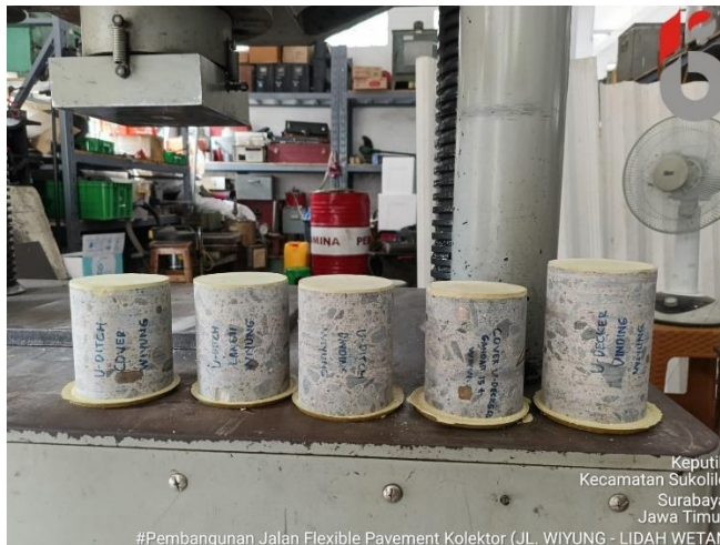
Gambar 4. 3 Benda Uji Kuat Tekan Beton (sumber : Dokumen Pribadi)
