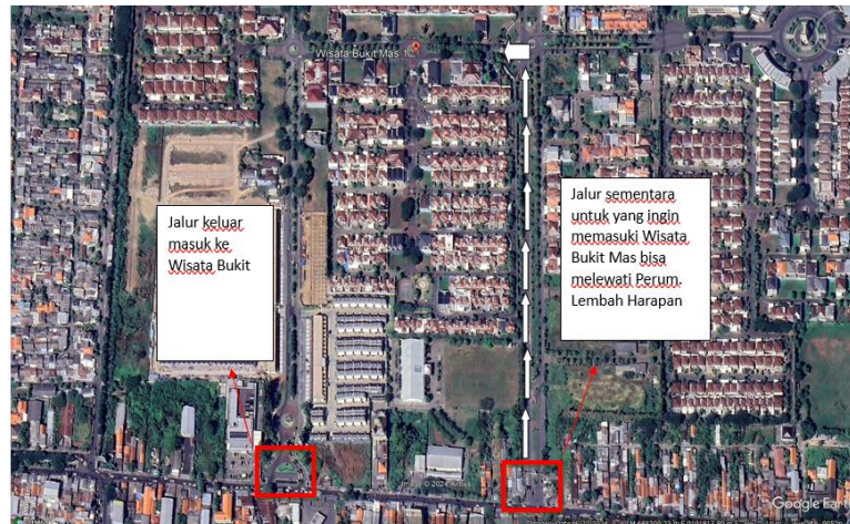
Gambar 6.4 Pemetaan Rekayasa Lalu Lintas di STA 0+200 – 0+250 (sumber : Dokumen Pribadi)
