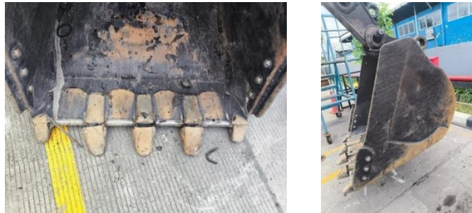
Gambar 1.1 Salah Satu Bucket Excavator Yang Hendak Direparasi
