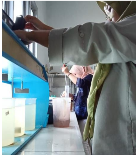
Gambar 2.7 Uji Jar Test
