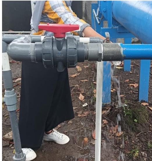
Gambar 2.9 Mengambil Sampel Dari Beak Tank
