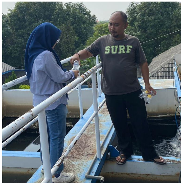
Gambar 2.11 Mengambil Sampel Air Clarifier IPA 3
