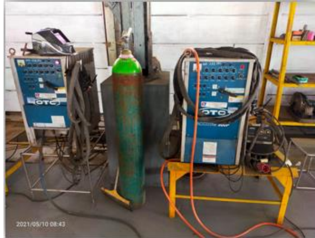
Gambar 2. 12 Mesin Las GMAW Sumber: Dokumen Pribadi PT INKA Multi Solusi
