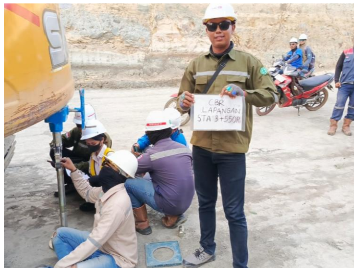
Gambar 9.9 Pengujian Kembali Tanah Yang Sudah Dipadatkan Sumber : Dokumen Pribadi
