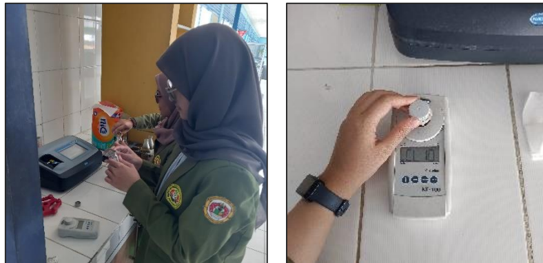
Gambar 2. 4 Pengujian Pada Parameter Sisa Klor Sumber: Dokumentasi Pribadi, 2024
