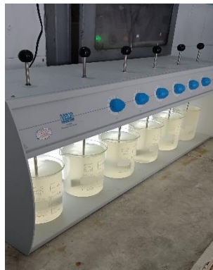
Gambar 2. 14 Penentuan Dosis Koagulan Menggunakan Jar test
