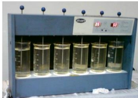
Gambar 2. 23 penelitian laboratorium menggunakan jar tester
