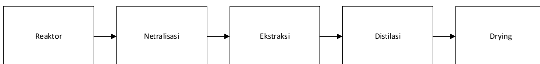
Gambar II.1 Pembuatan Asam Fenil Asetat dengan Proses Karbonilasi
