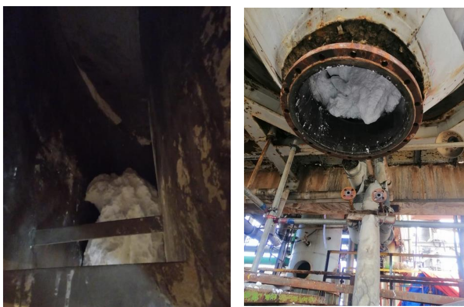
Gambar VIII. 1 Kondisi Konsentrator saat Mengalami Scalling
