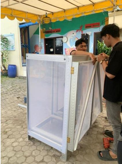
Gambar 2. 3 Pemasangan Fiber dan Pintu
