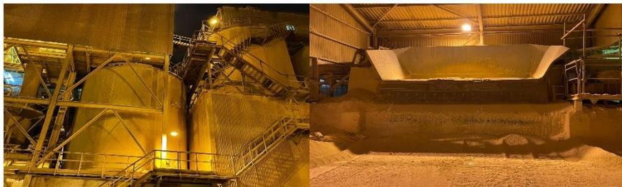
Gambar II. 18 Silo (D-2201. AB) dan Hopper 9D-7113. AB)
