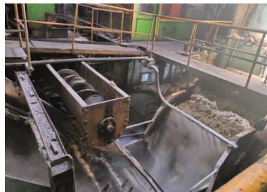
Gambar 3. Penambahan air imbibisi pada proses penggilingan tebu
