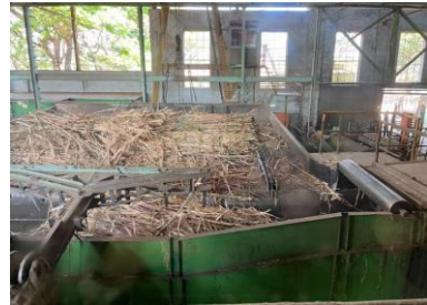
Gambar 2. Proses pengangkutan tebu dari truk menuju cane table
