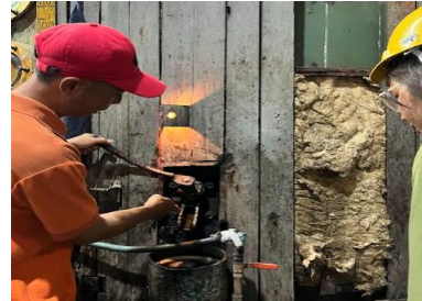
Gambar 8. Proses pengambilan sampel gula pada stasiun masakan
