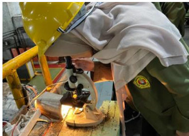
Gambar 9. Proses pengecekan ukuran gula di stasiun masakan
