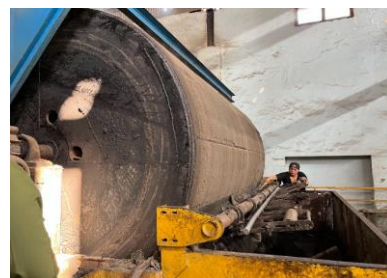
Gambar 6. Proses Rotary Vacuum Filter dalam menghasilkan blotong
