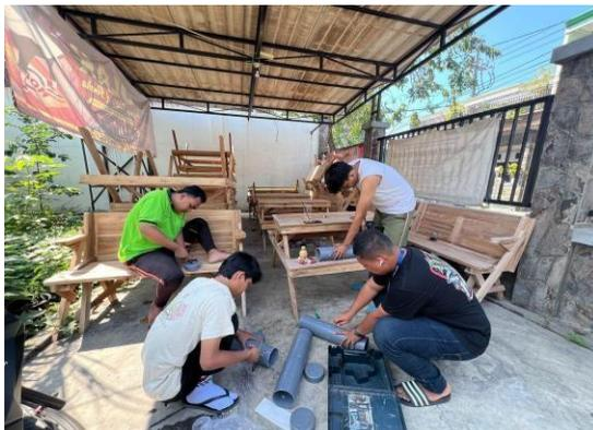
**Gambar 2.3** Pembuatan Alat Pipa Biopori
