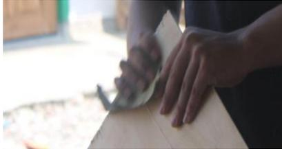
Gambar 3.15 Menghaluskan triplek dengan amplas
