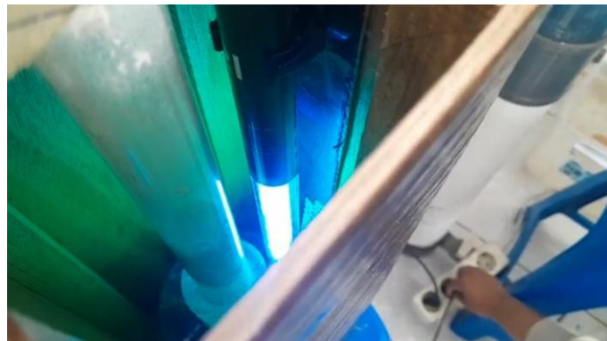
Gambar C.3 Reaktor Kontinyu Fotokatalis
