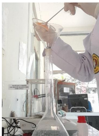
Gambar C.2 Proses Pembuatan Limbah Artifisial
