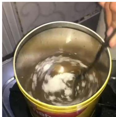
Gambar 2.5 Penyampuran jelantah dengan bleaching earth
