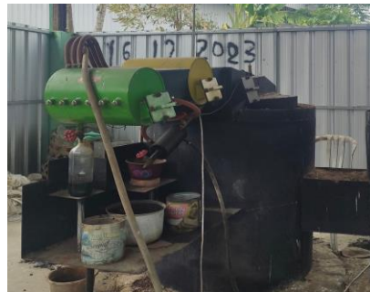
Gambar 2.23 Pemecahan Fraksi Minyak Hasil Pirolisis
