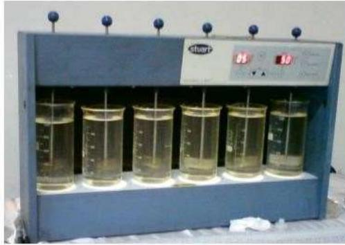
Gambar 2. 4 Peralatan Jar Test
