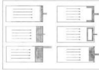
Gambar 2. 5 Susunan pelimpah pada zona outlet pengendap
