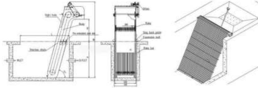
Gambar 2. 1 Unit Bar Screen Mekanik dan Manual
