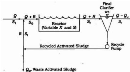
Gambar 2. 6 Proses pada Activated Sludge
