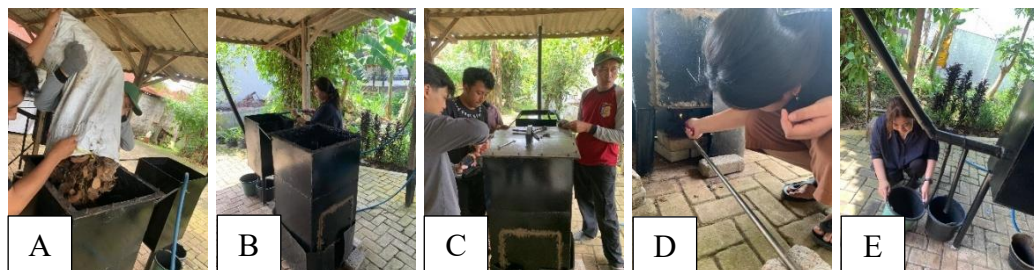
Gambar 5. 12 Pembuatan Asap Cair, (A) Pemasukan tempurung kelapa, (B) Pengisian air pada drum, (C) Penutupan drum, (D) Pembakaran alat pirolisis, (E) Pengecekan hasil asap cair
