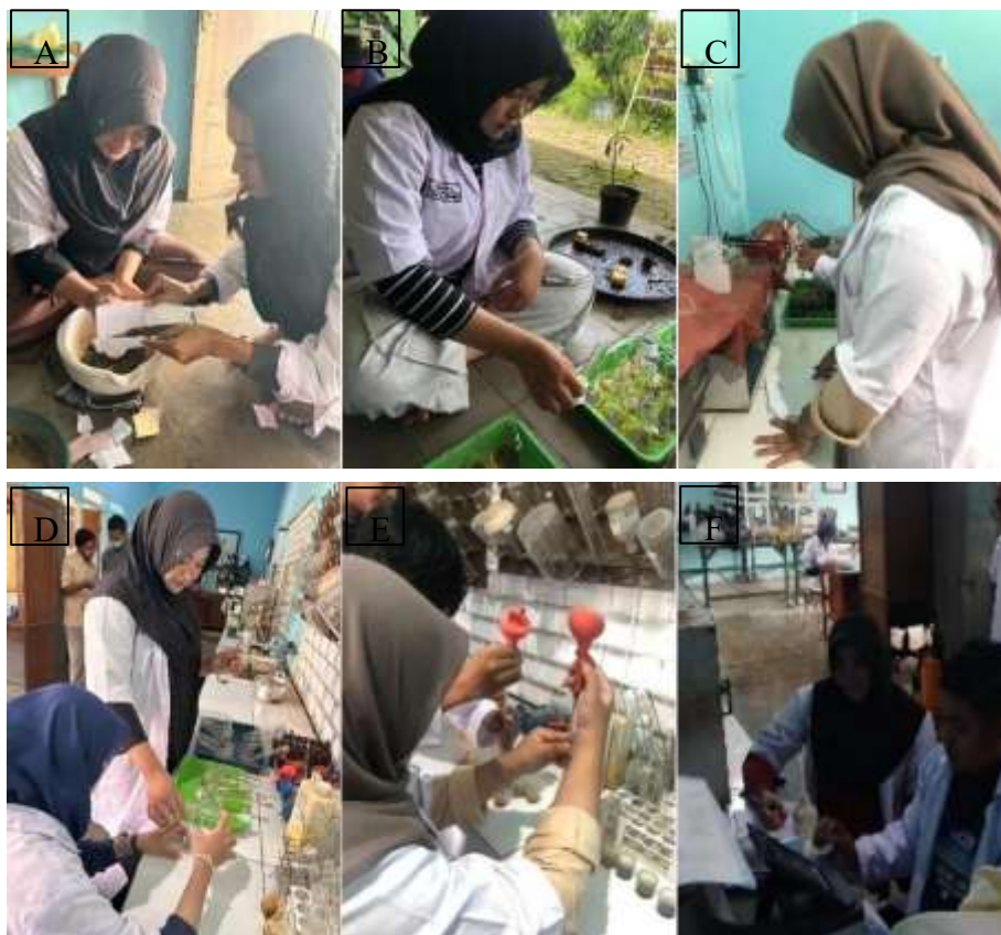
Gambar 5.4. Menumbuk Sampel Tanah (A); Analisa C-Organik (B); Analisa Ph, EC, Redoks (C); Analisa N-Total (D), Analisa P dan K (E); Pembacaan Hasil Analisa Menggunakan Spektrofotometer
