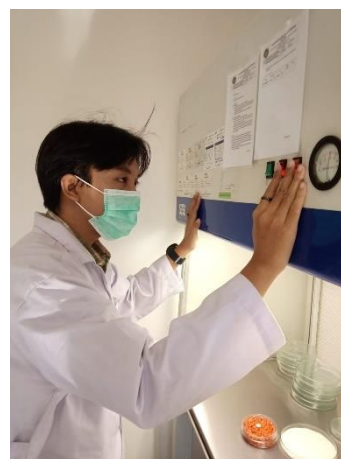
Gambar 5. 9 Menyalakan blower dan lampu LAF
