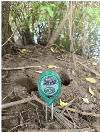
(d).Pengukuran kelembapan tanah
