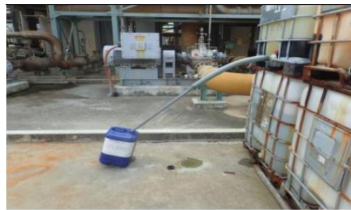
Gambar 10. Pemindahan HCl 35% dari IBC ke Jerigen Sebelum dituang ke Bak Acid Cleaning Untuk Demister
