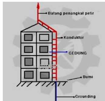
Gambar 5.11. Sistem Instalasi Penangkal Petir
