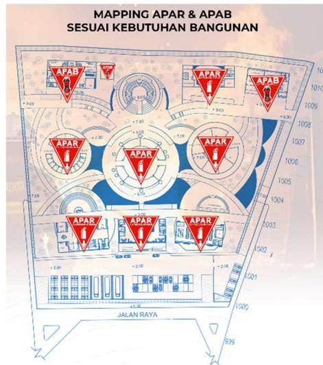
Gambar 6.24 Klasifikasi Alat Pemadam Api Berdasarkan Bangunan
