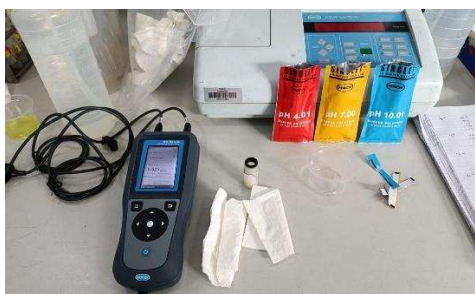
Gambar 2. 15 Kegiatan Verifikasi dan Kalibrasi Alat
