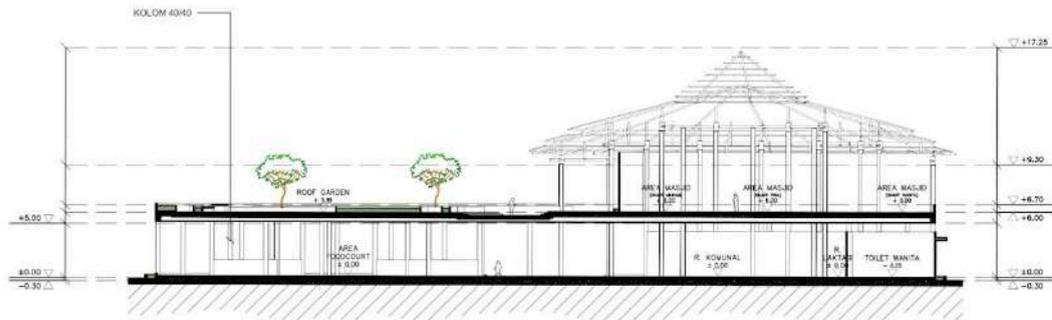
Gambar 6.6 Potongan A Bangunan Utama Rest Area
