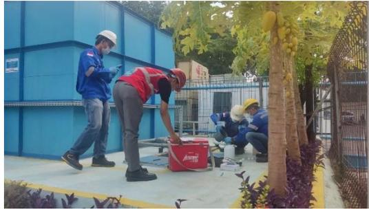
Gambar 2.4 11 Inspeksi Pekerjaan Pengambilan Sampel Air Limbah
