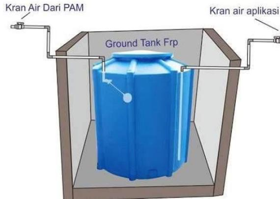
Gambar 2. 18 Reservoar Fiberglass
