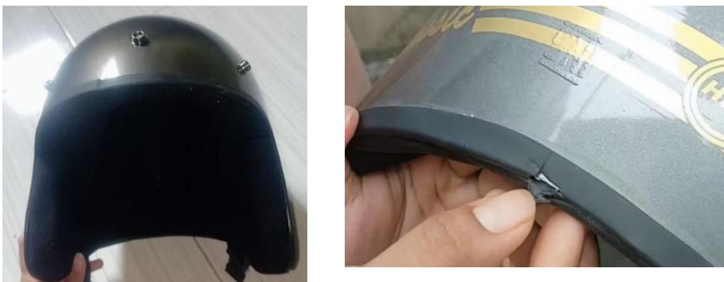
Gambar 1.2 cacat yang terjadi selama proses produksi helm bogo
