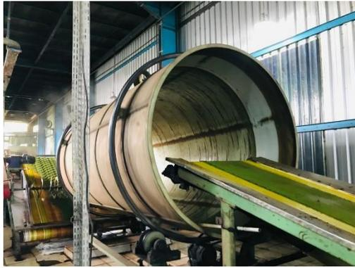
Gambar 2.8 Proses Penangkapan Serat oleh *Googie*
