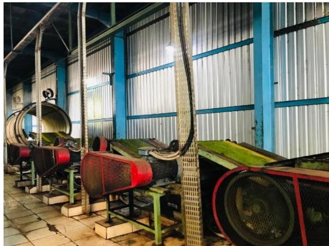
Gambar 2.7 Proses Penggilingan dengan Mesin *Teaman*
