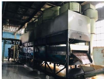
Gambar 2.11 Proses Pengeringan Menggunakan VFBD
