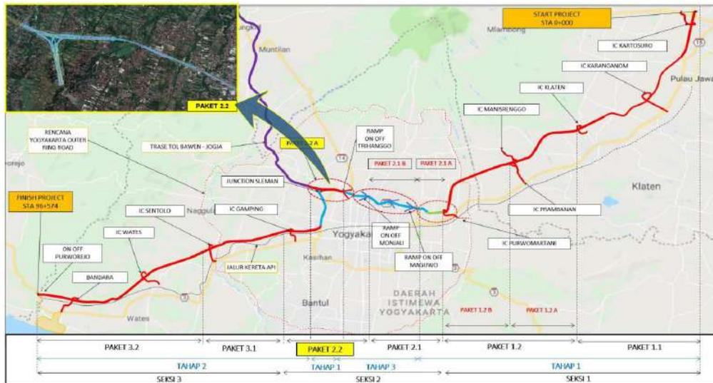
**Gambar 1. 1 Layout keseluruhan proyek pembangunan jalan Tol**
