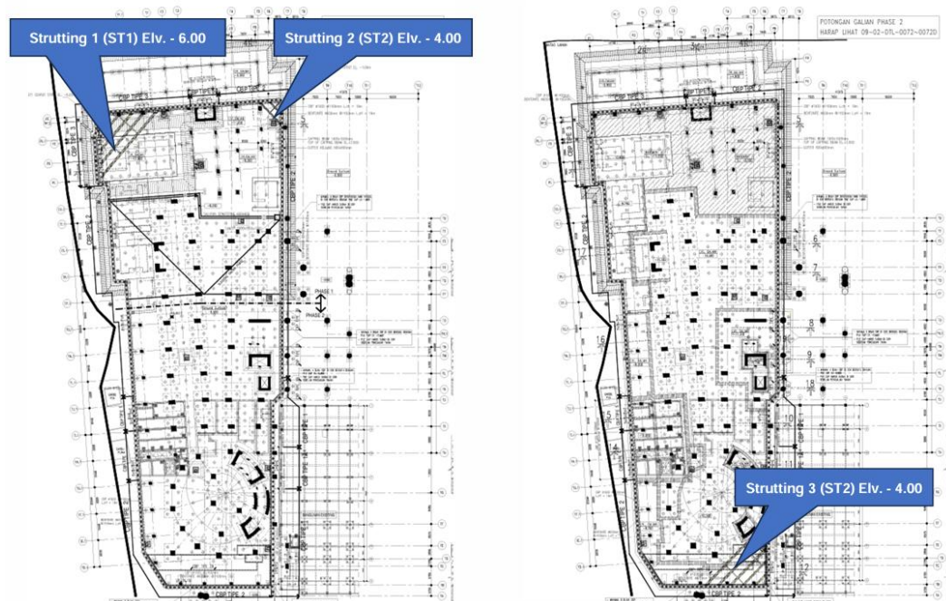
Gambar 8. 3 Perletakan Baja Strutting Pada Proyek Pemabangunan EKA HOSPITAL BSD
