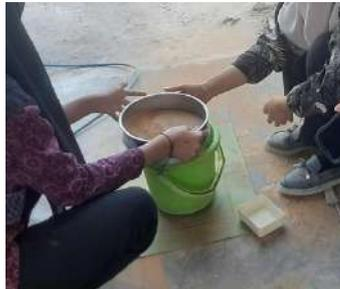
Gambar 2. 18 Proses Pengujian Kehalusan Produk
