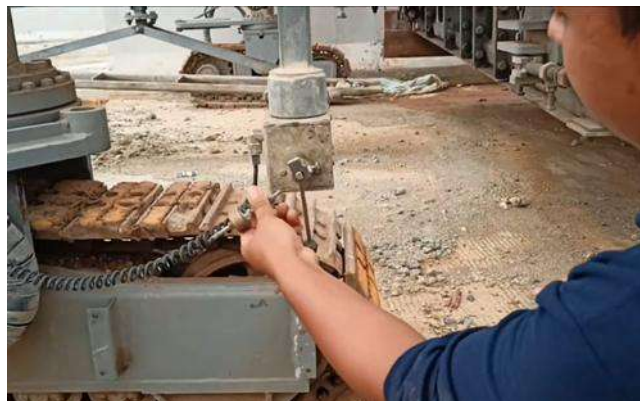
Gambar 10.4. Persiapan Sensor Untuk Lintasan Wirtgen
