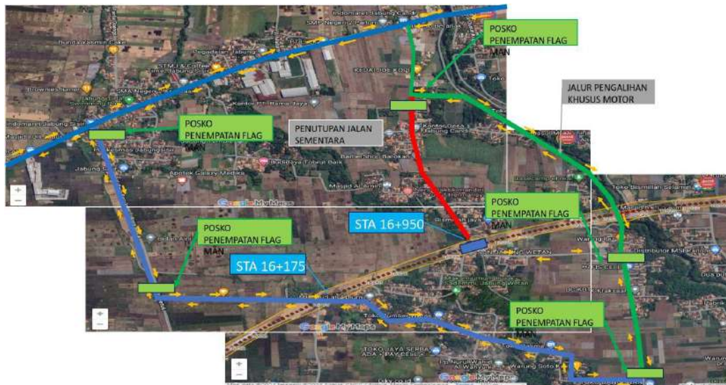
Gambar 6.8. Rekayasa Lalu Lintas pada Saat Erection Girder
