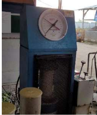
Gambar 3.2. Pekerjaan Pengujian Kuat Tekan Beton
