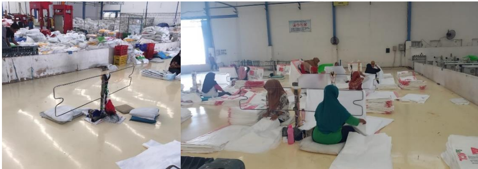
Gambar 2.12 Pemasangan Inner secara Manual
